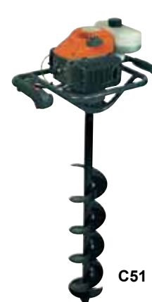
MOTOTRIVELLE/MOTOR DRILLS/FOREUSES À MOTEUR C51 - 85R Con motore a scoppio / Petrol or electric motor / À moteur à explosion Potenza/Power/Puissance: 2 - 6 Hp Peso/Weight/Poids: 9 - 30 kg Foratura fino a/Drilling up to/Forage jusqu'à 200 mm (C51) Foratura fino a/Drilling up to/Forage jusqu'à 500 mm (85R)
