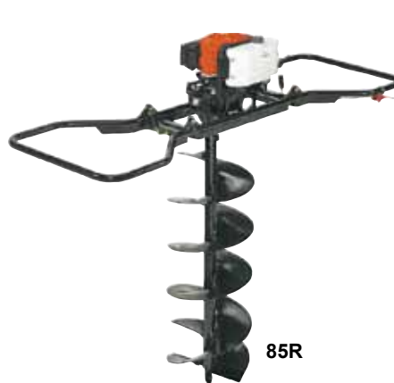
MOTOTRIVELLE/MOTOR DRILLS/FOREUSES À MOTEUR C51 - 85R Con motore a scoppio / Petrol or electric motor / À moteur à explosion Potenza/Power/Puissance: 2 - 6 Hp Peso/Weight/Poids: 9 - 30 kg Foratura fino a/Drilling up to/Forage jusqu'à 200 mm (C51) Foratura fino a/Drilling up to/Forage jusqu'à 500 mm (85R)
